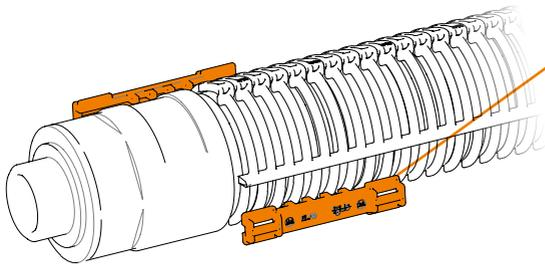
! 4 Zähne zeigen in Richtung des geschlossenen Teils der e-rib
