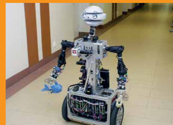
Autonomer Roboter FLASH mit 2 robolink®-Gelenkarmen mit je 4 Freiheitsgraden [technische Universität Breslau, Polen]
