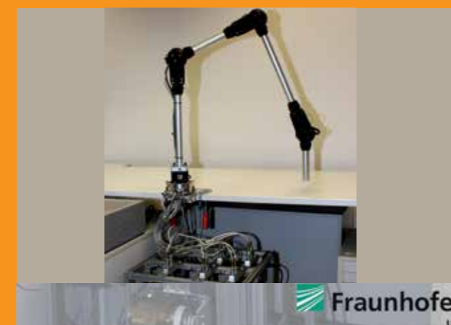
Sonderkonstruktion mit 4 DOF: 3 Gelenke in Reihe [Fraunhofer IFF Magdeburg]
