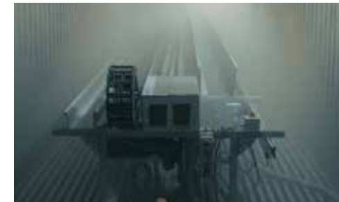
Kältetest bei -40°C von chainflex® Leitungen und e-ketten®
