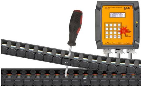
Werden offene Energiezuführungen blockiert, steigen die Verschleibewerte. Die neue kompakte Auswerteeinheit igus PPDS.EU.01 signalisiert den Zustand bei allen Verfahrwegslängen, sodass über die Anlagensteuerung alle Motoren gestoppt werden können. (Quelle: igus GmbH)
