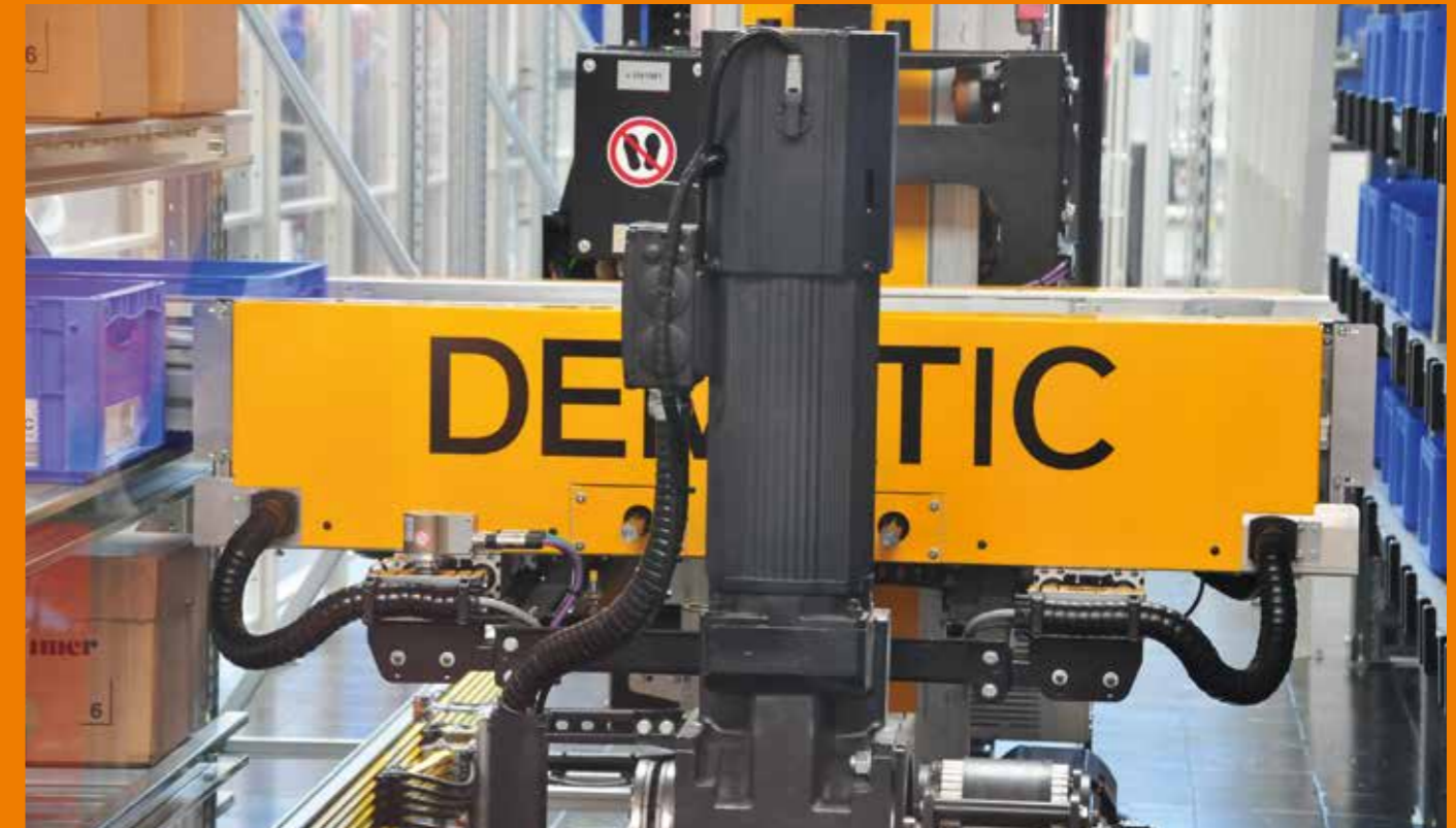
triflex® R im Regalbediengerät
