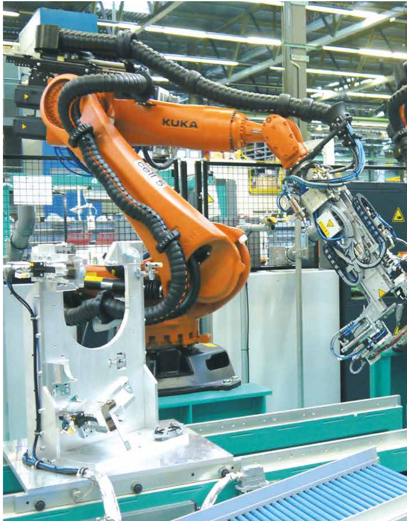
triflex® R e-ketten® für multidimensionale Bewegungen und stehende E2 mini e-ketten® an der Handlungseinheit
