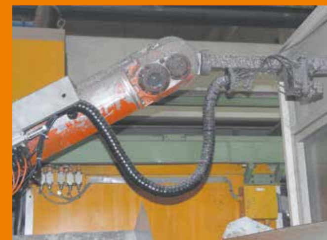
triflex® R in einer Magnesium-Druckgiesserei - Ausfallsicher trotz Hitze, Schmutz, Öl und Späne
