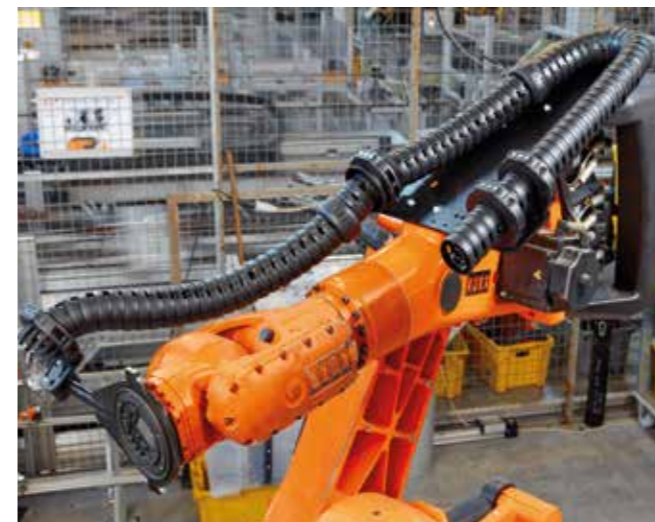
triflex® RS für eine schlanke e-ketten® Führung. Integrierte Federstäbe erzeugen eine Rückzugskraft, die eine Schlaufenbildung verhindern
