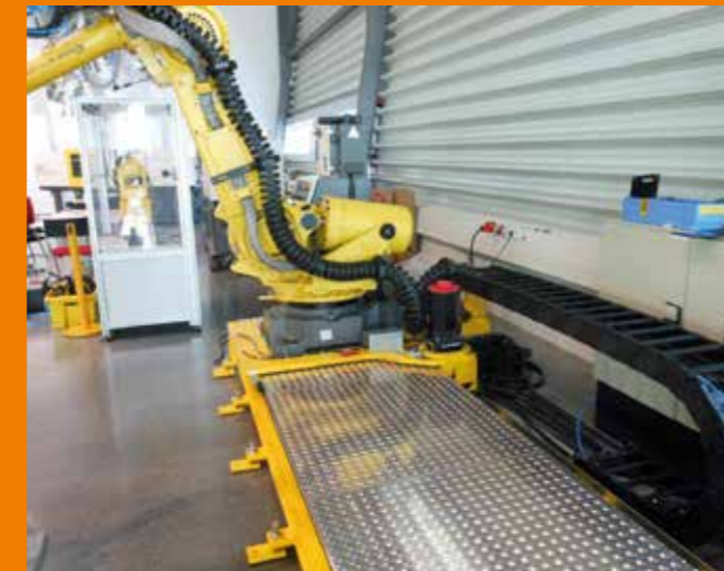
triflex® R an Achse 1-6, E4.1 an Achse 7 des Roboters
