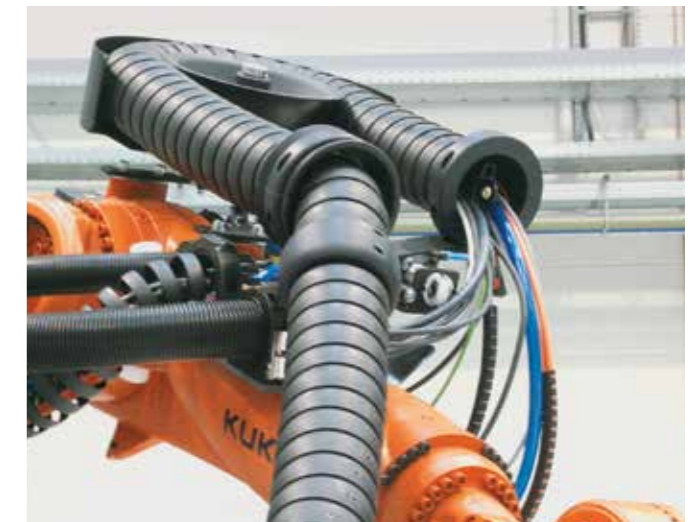
Pneumatisches Rückzugssystem igus® triflex® RSP - verhindert Schlaufenbildung am Roboter
