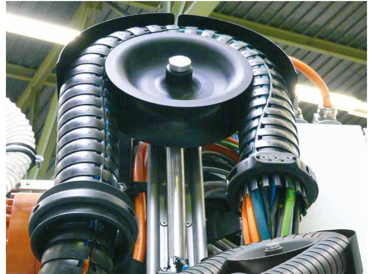
Pneumatisches Rückzugssystem triflex® RSP - verhindert Schlaufenbildung im Arbeitsbereich des Roboters
