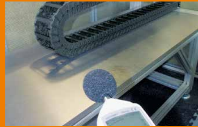
Geräuschprüfung in igus® eigener Schallkabine
