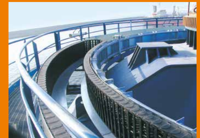
Dreh-Energieführung E4 RBR versorgt Hafenkran mit Energie - Drehbewegungen
