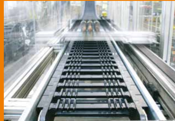
Dauerversuch Lebensdauer und Verschleiß
