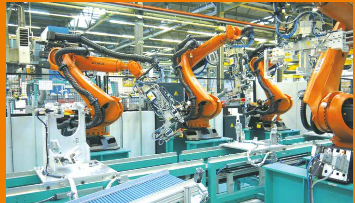
Flexible Produktion - Anlage für die Produktion von Fahrzeugtanks aus Kunststoff. Um den Endkunden in der Automobilindustrie die größtmögliche Flexibilität bieten zu können, werden die Produktionsanlagen nur noch mit Robotern ausgerüstet. Die igus® RSP-Systeme verhindern eine Schlaufenbildung der e-ketten® durch die drei-dimensionalen Bewegungen der Roboter.
