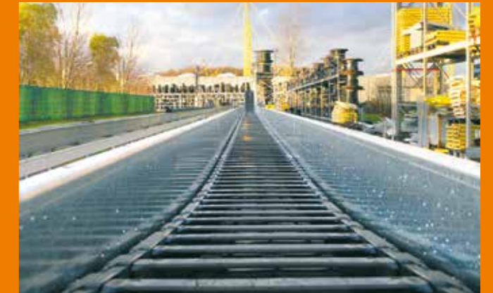
Prüfplatz Fahrweg 125 m, Geschwindigkeit 300 m/min
