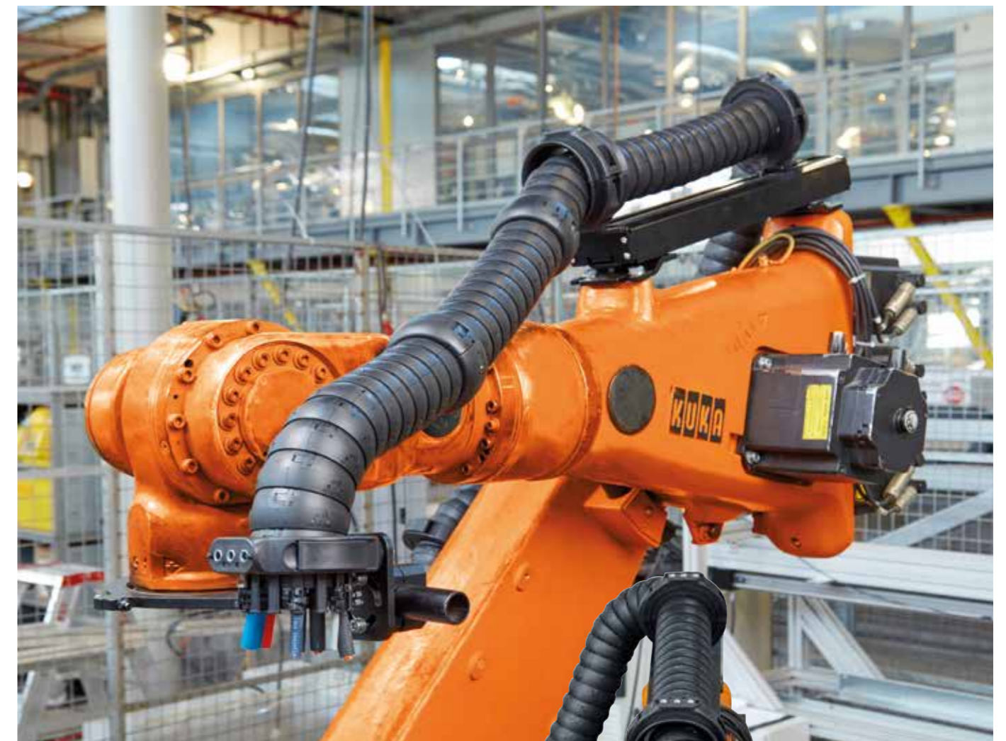
triflex RSEL - kostengünstige und platzsparende Führung der e-kette®
