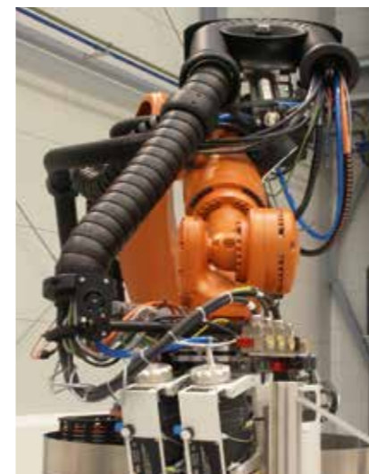
igus® chainflex® Leitungen im Einsatz in mehrdimensional beweglicher Energieführung triflex® R für 6-Achs-Roboter
