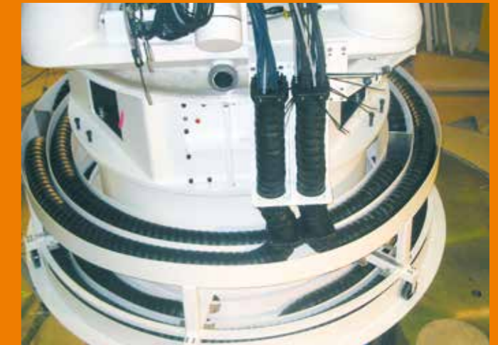
triflex® R in einem Laser-Mess-Teleskop. Drehbewegung in beide Richtungen \leq 310^\circ
