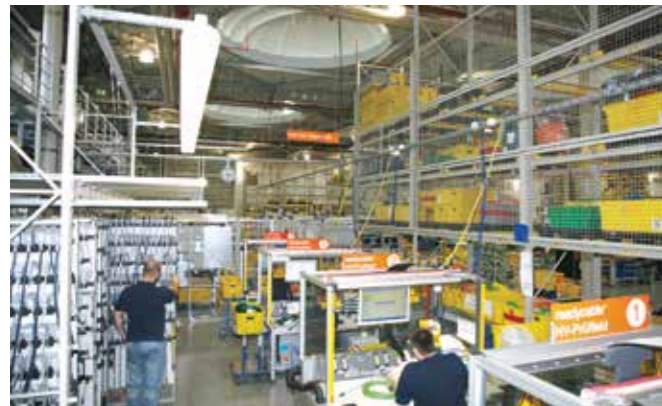
Rechnergestützte Hochspannungsprüfung und Endkontrolle aller konfektionierten Leitungen
