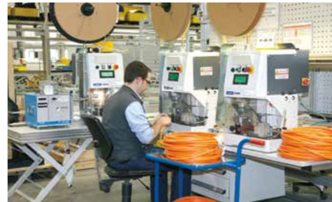
Moderner Maschinenpark: automatische Stripper-Crimper
