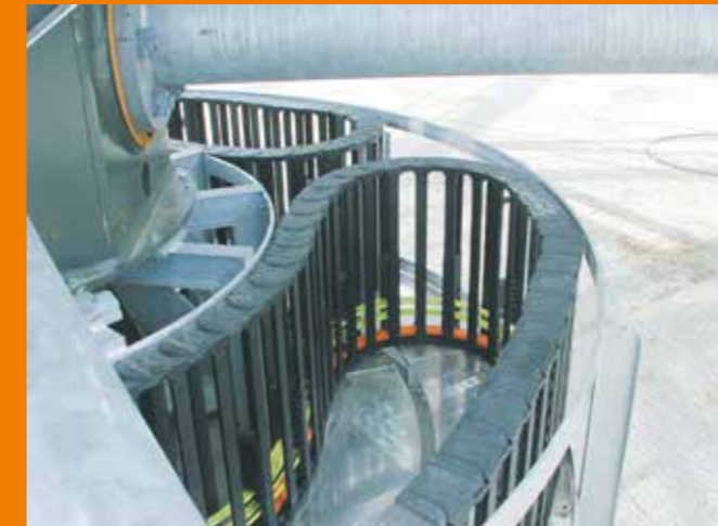
Dreh-Energieführung System E4 RBR in einem Spiegelteleskop, welches starken Schnee- und Sandeinfällen ausgesetzt ist
