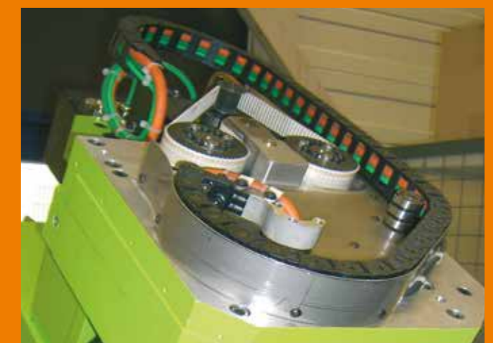
E2 mini, Serie B15 - Die Motorspindel hat einen Schwenkbereich von ca. 210^\circ
