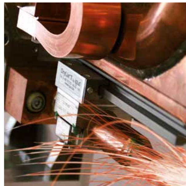
Schweißzange am Roboterkopf mit igus® drylin® T
