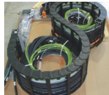
Montageoptimierte Anlieferung Assembly-optimized delivery
