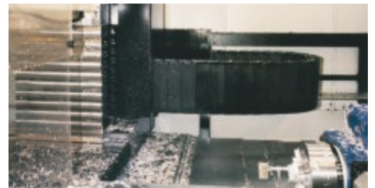
R188 "auf der Seite" – spänedichtes E-Rohr in einer Werkzeugmaschine Chips-safe series R188 for side-mounted application
