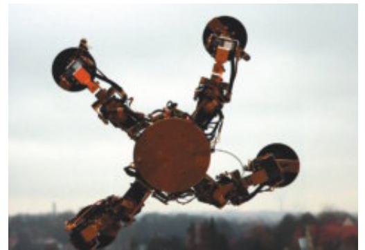
Kletterroboter mit superleichten iglidur®-Lagern. Climb-robot with ultralight iglidur® bearings
